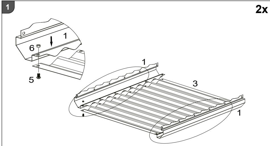
1. Verschrauben Sie zwei der Eckverbindungen **1** mithilfe von jeweils sechs Schrauben **5** und sechs Muttern **6** am Paneel **3**.
