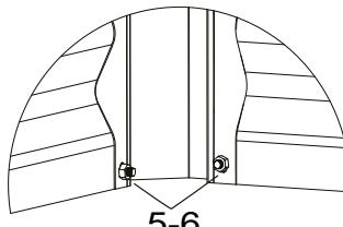
9. Setzen Sie das Paneel **3** an die Paneele **2** an und verbinden Sie es an den Eckverbindungen **1** mit jeweils sechs Schrauben **5** und sechs Muttern **6**.
