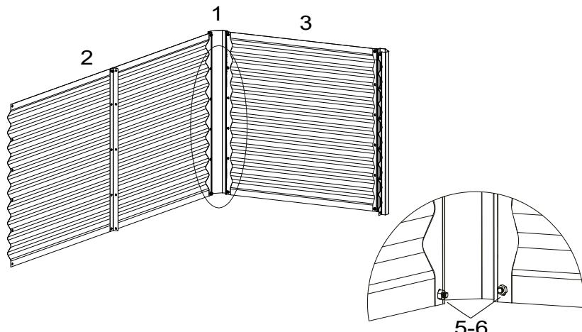
5. Setzen Sie das Paneel 3 an das Paneel 2 an und verbinden Sie es an der Eckverbindung 1 jeweils mit sechs Schrauben 5 und sechs Muttern 6.
