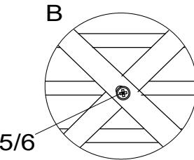
7. Verschrauben Sie die beiden Querstangen **7** jeweils an den zwei gezeigten Stellen mit den Verbindungselementen **8**. Verwenden Sie dazu jeweils zwei Schrauben **5** und zwei Muttern **6** (siehe **Abb. 5A**).
