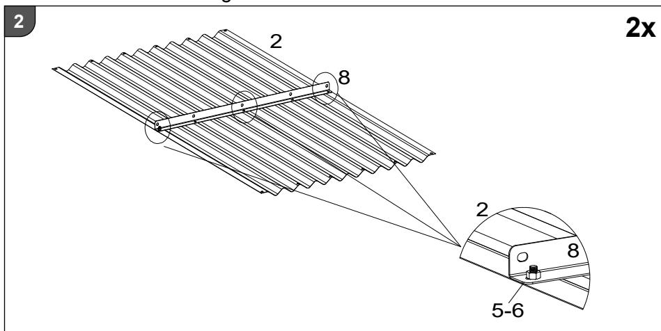
3. Verschrauben Sie das Verbindungselement **8** mithilfe von drei Schrauben **5** und drei Muttern **6** an den gezeigten Stellen auf dem Paneel **2**.
