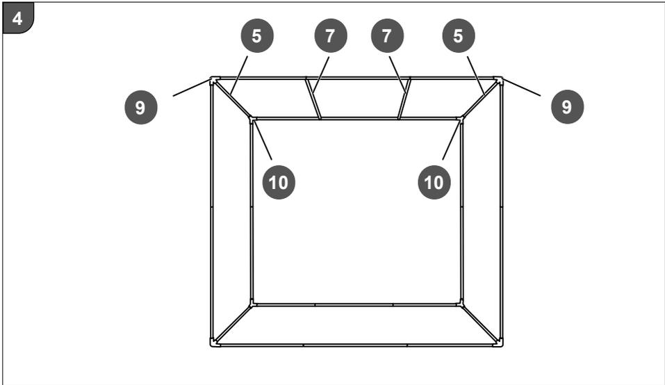
6. Zum Montieren der Dachkonstruktion befestigen Sie die Eckverbindungen **9** für die Vorderseite des Gewächshauses und die Eckverbindungen **10** für die Rückseite des Gewächshauses (siehe **Abb. 4**).
