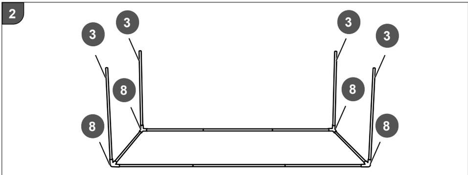
3. Stecken Sie die Seitenstreben 3 in die zuvor montierten Eckverbindungen 8 und kontrollieren Sie sie auf festen Sitz (siehe **Abb. 2**).
