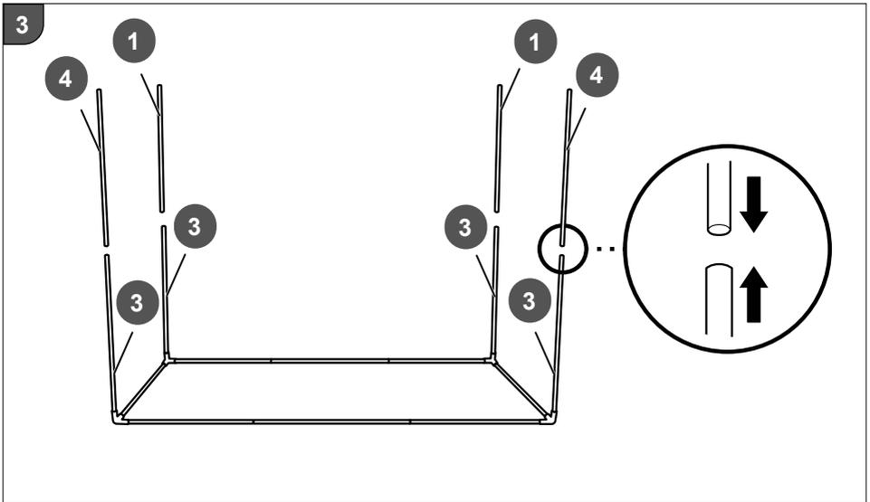
4. Erhöhen Sie die Seitenstreben **3**, indem Sie sie auf der Vorderseite jeweils mit den Streben **4** sowie auf der Rückseite jeweils mit den Streben **1** verlängern (siehe **Abb. 3**).
