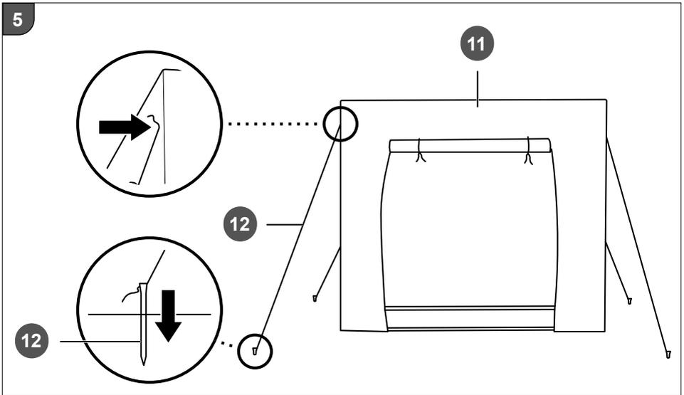
8. Stülpen Sie abschließend die Folie **11** des Gewächshauses über den Rahmen. Beachten Sie, dass die Folie faltenfrei über der Konstruktion liegen muss.
