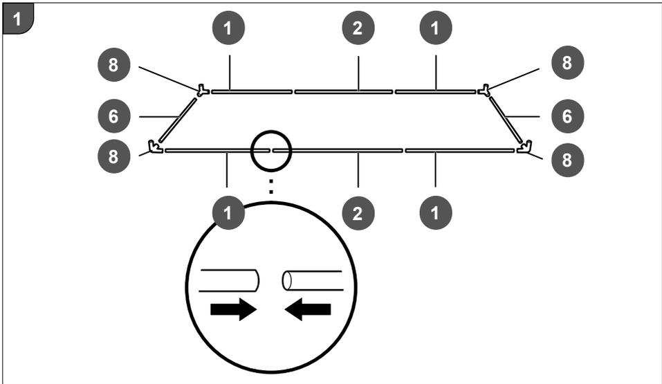
1. Beginnen Sie mit dem Aufbau, indem Sie den Rahmen für den Boden auf einem ebenen Untergrund zusammenstecken. Verwenden Sie hierfür die Streben (1, 2, 6) und die Eckverbindungen 8 (siehe **Abb. 1**).
